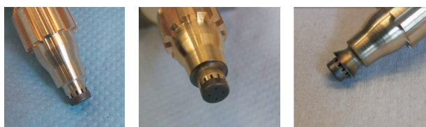
(a) 普通构型 (b) 针栓尖端有主动冷却 (c) 轴向流道加导流板
