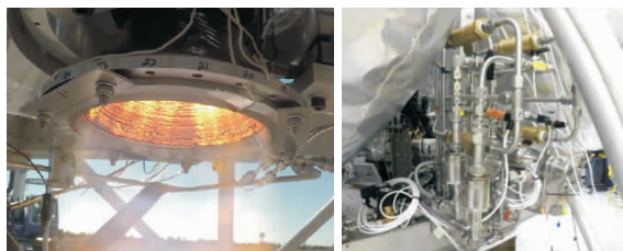
图4 氦气热交换器(左)和氦气压力/流量调节面板(右)
