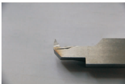
图5 复合V形槽加工刀具
