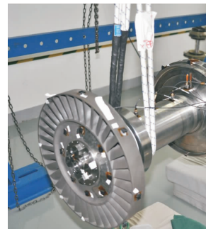
图2 涡轮盘模态试验
