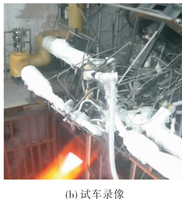
图 10 缩尺推力室热试车
