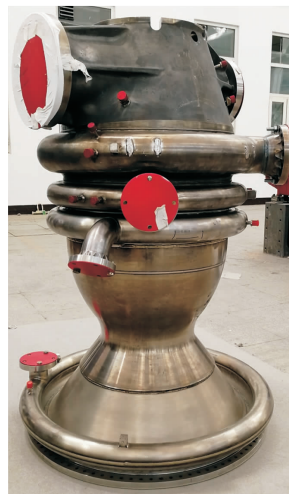
图 15 全尺寸短喷管推力室
