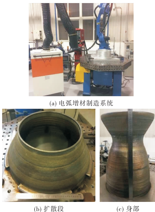
图14 电弧增材制造系统及产品
