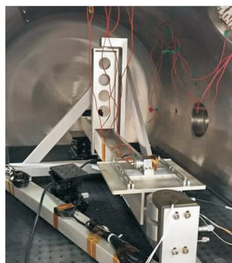
图 9 真空微弧推进系统推力测试台架
