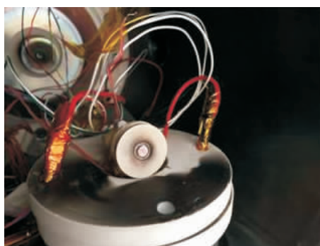
图 4 推力器安装在真空舱内
