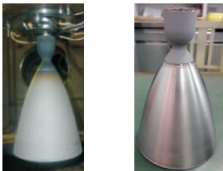
(a) 热试车后合金喷管 (b) 燃烧室与合金喷管焊接身部
