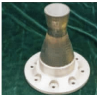
图12 铱/铼/碳-碳复合材料燃烧室
