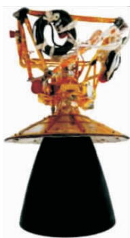
图 11 远征三号上面级 5 000 N 发动机
