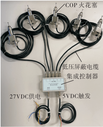
图 3 COP 电火花点火控制系统实物照片
