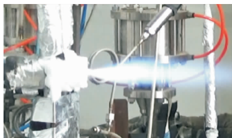
图 7 5 kN 发动机模拟火炬点火器稳态热试车
