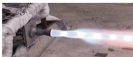
图 9 5 kN 发动机 (铌钨合金燃烧室) 稳态热试车
