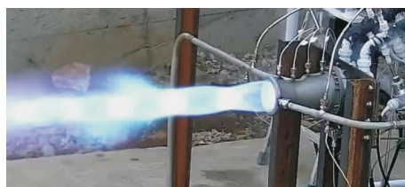
图 8 5 kN 发动机 (3D 打印水冷燃烧室) 稳态热试车
