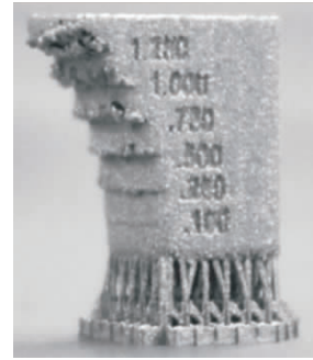
图 14 3D 打印悬垂结构设计原则
