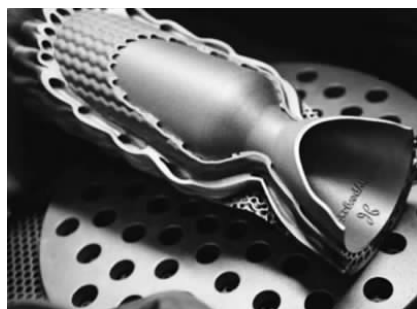
图 12 发动机再生冷却燃烧室集成设计
