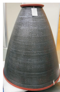
图 7 陶瓷基复合材料喷管延伸段实物
