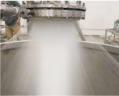
图 2 喷注器雾化场照片 Fig. 2 Image of injector atomization field
