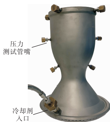
图3 再生冷却身部实物
