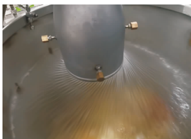
图5 再生冷却身部液流试验
