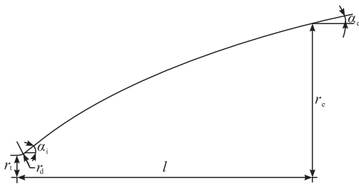
图2 抛物线喷管设计示意图
