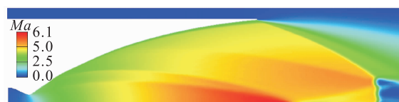
(a) SSME流动分离计算马赫数云图(密集网格)
