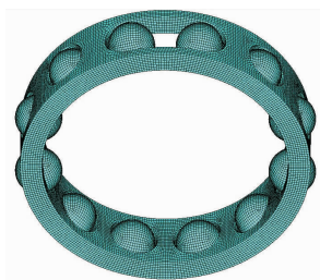
图 6 保持架断裂后的有限元网格
